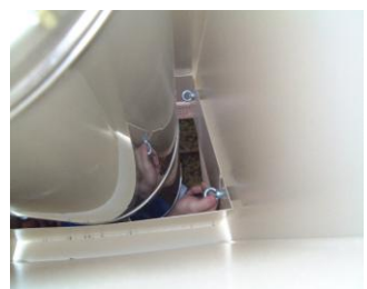
Étape 2b : Mettre le fût de niveau et le bloquer avec les anneaux de serrage.
